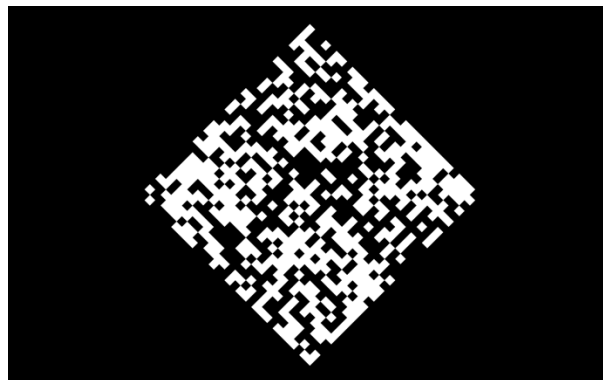
Figur 26 Exempel på binär mask som visas på DMD1 med 30x30 element i upplösning.
