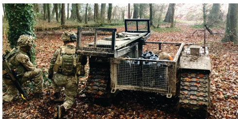
Figur 2.3: THeMIS UGV med bår monterad under AWE18 (foto: FOI).
