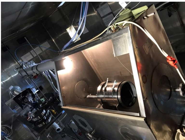
Figur 11. Behållaren i handskboxen, till vänster syns utsugsröret där en fläkt suger ut blandningen från boxen.
