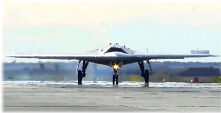
Figur 4.5: Prototyp av rysk UCAV Suchoj S-70 Ochothnik-B som är under utveckling med planerad leverans 2024 (foto: Geektrooper2, CC BY-SA 4.0, via wikipedia 245 ).
