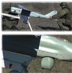
Figur 3.2: Orlan-10 UAV, och dess EO/IR-sensorer, som övervakade vapenvilan i Nagorno-Karabach, februari 2021 (foto: mil.ru 84 , Creative Commons Attribution 4.0).
