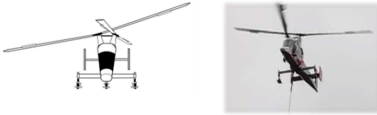
Figur 4.2: Kaman K-MAX med två motroterande synkroniserade rotorblad (vänster – Fox 52, CC BY-SA 3.0, via wikipedia 198 ; höger – Tethys, via wikimedia commons 199 ).
