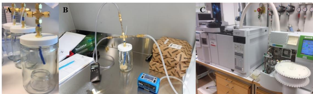
Figur 3. A) Explosivämnena placerade i provtagningsburkar med lock för provtagning. B) Vid provtagning monterades rören. De tre pumparna startades samtidigt för att provta ett triplikat. C) Adsorbenttrören analyserades med ATD-GC/MS.
