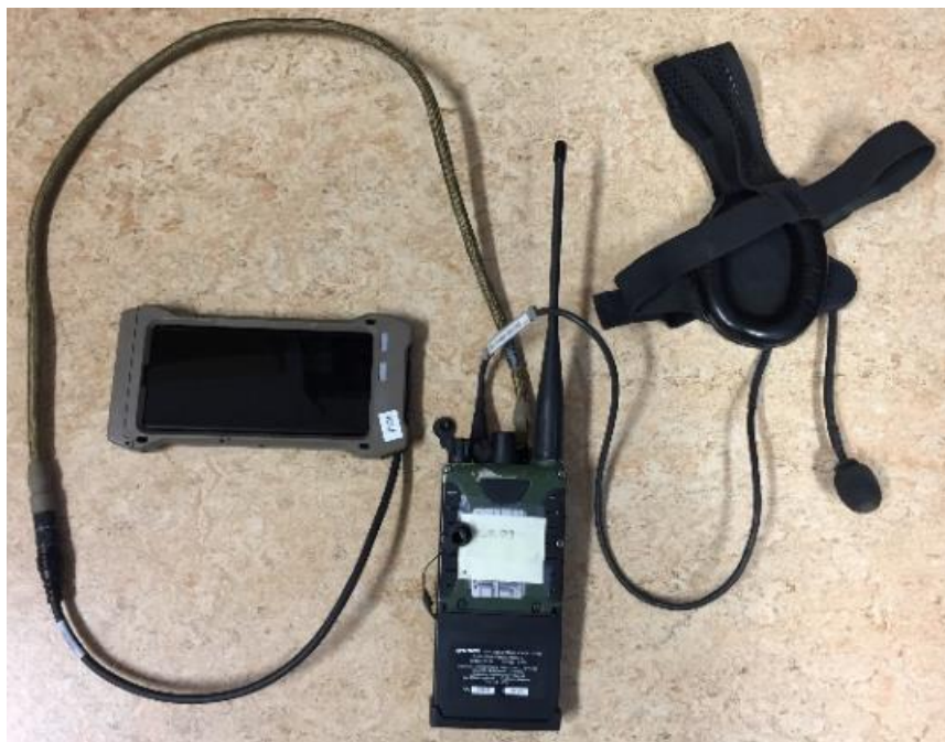
Figur 2. Kabeluppsättning för direktkoppling mellan EUD och Ra1570. Till höger inkopplat headset.
