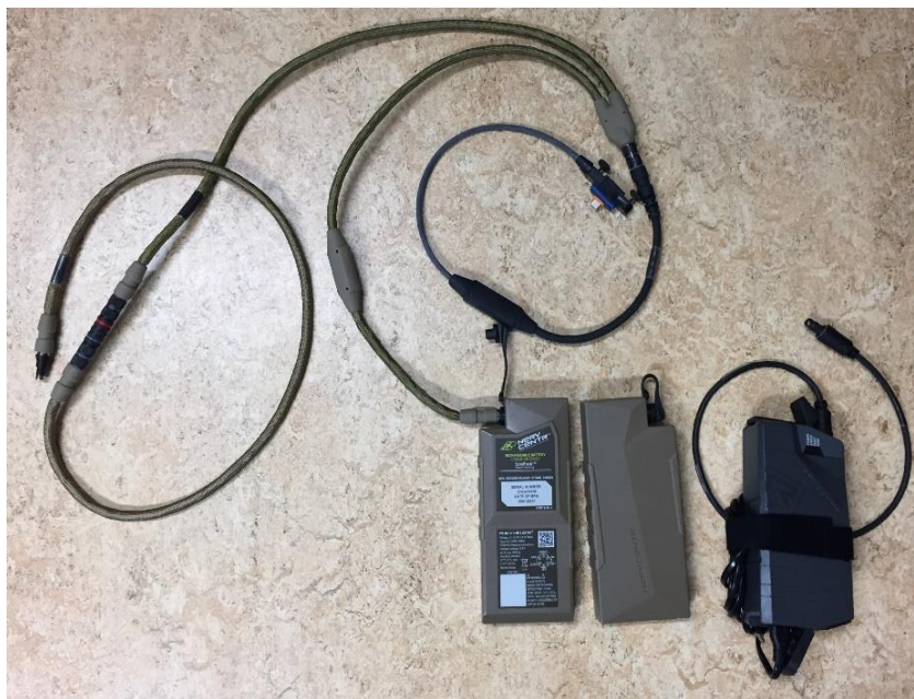
Figur 3. Y-kablage och externt batteri (2 st) för laddning under användning. Till höger batteriladdare för externt batteri.
