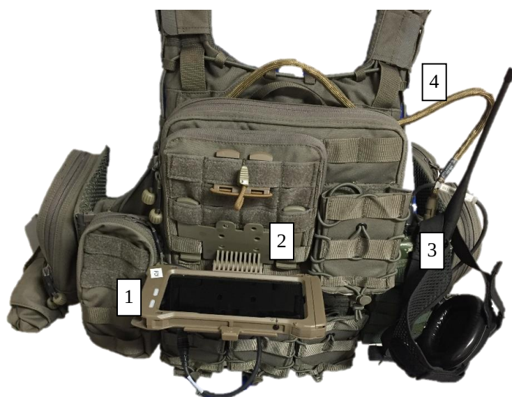
Figur 1. EUD (1) monterad i hållare (2) fäst på demo-stridsväst från FOI, samt Ra1570 (3). Kablaget (4) är här ej trätt genom MOLLE-öglor.
