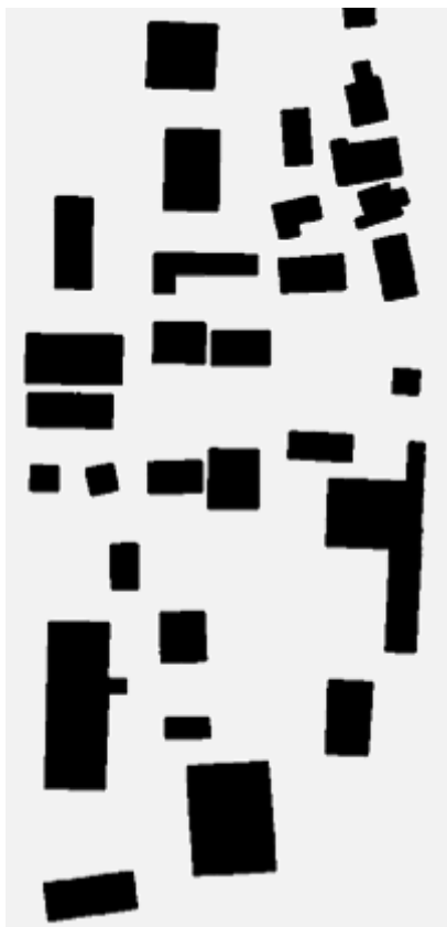
Figur 4. Exempel på sannolikhetsraster över ett industriområde (upplösning 5 m/pixel). De svarta silhuetterna är byggnader. Eventuella mål som befinner sig inom sådana områden får en modifierad upptäcktsannolikhet lika med noll.
