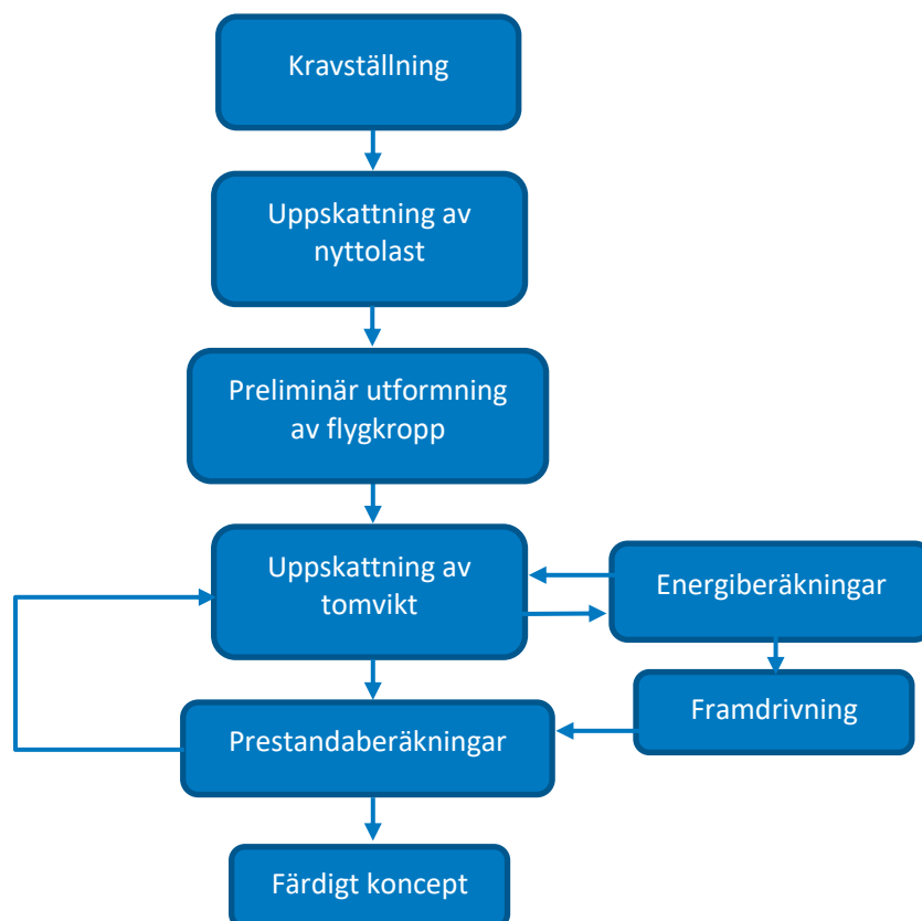
Figur 2. Schema över designprocessen för patrullrobotkonceptet.
