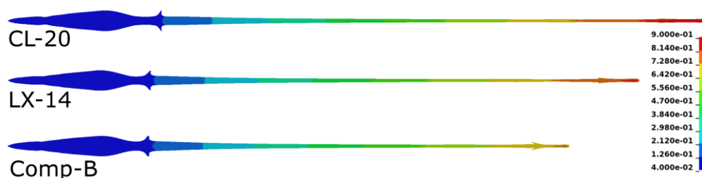
Figur 3. Simulerad strålbildning med tre olika sprängämnen med stigande prestanda. Bilderna visar strålens profil 90 \mu s efter initiering och färgskalan visar hastigheten (cm/ \mu s).
