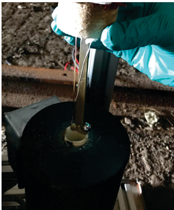
Figur 6. Mekanisk utlösare laddad med 11,1 mm kula (Foto: Dan Martelin).
