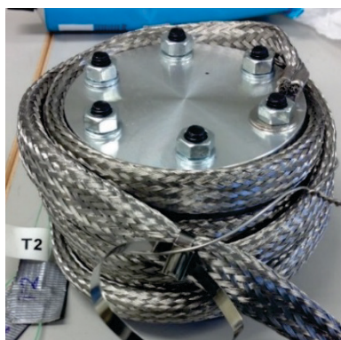
Figur 2. Stålhölje omlindat med värmeband som används i ICOT-försöken (Foto: Dan Martelin).
