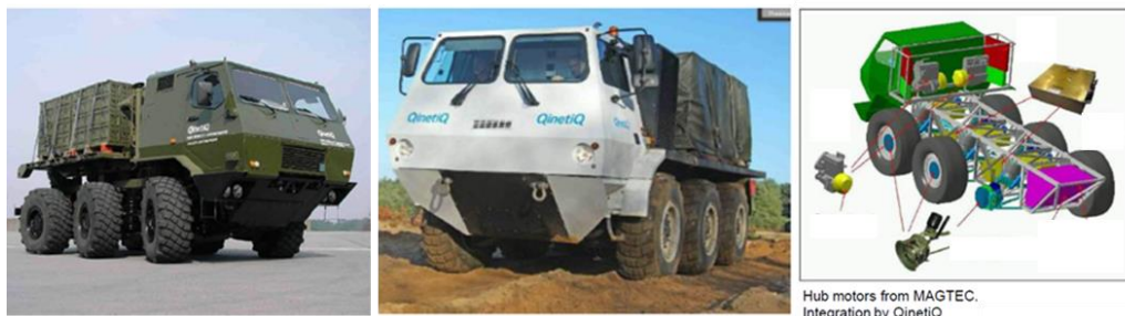
Figur 11. Hybridelektriskt fordon med navmonterade elmotorer [31].
