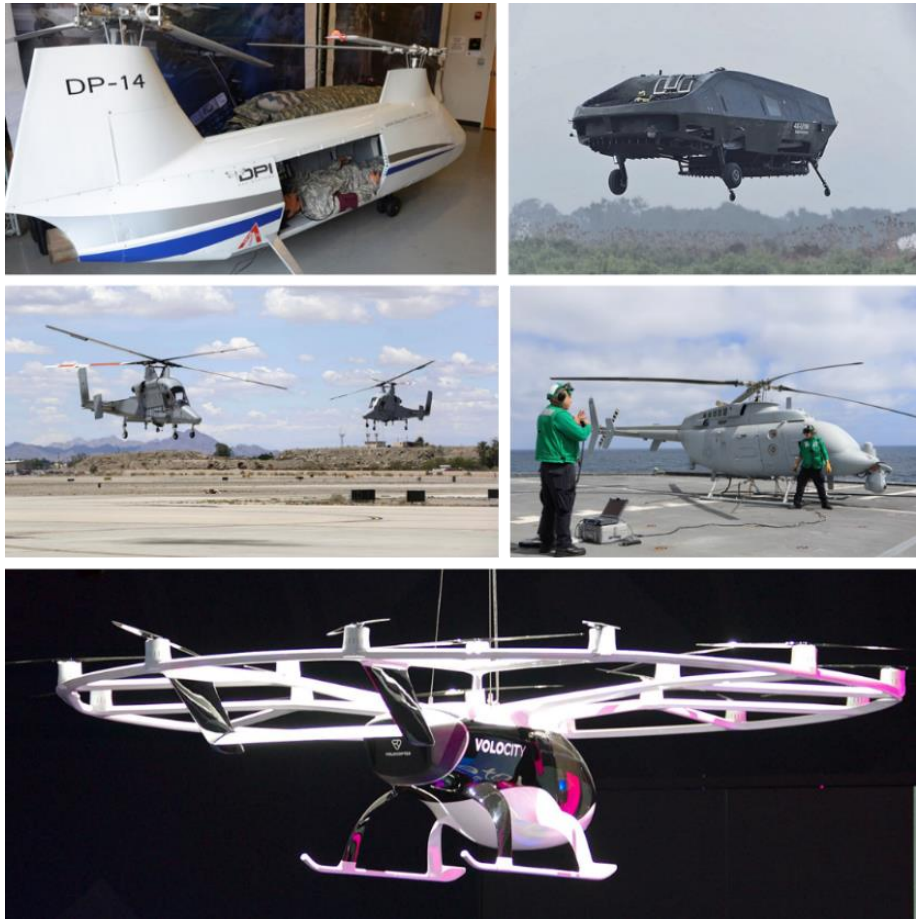
Figur 4.4: DP-14 UAV med möjlighet att transportera en skadad, januari 2017 (foto: US Army Acquisition Support Center, public domain, via wikimedia commons 27 ). Tidig version av Cormorant UAV, juli 2020 (foto: Rafi Yoeli, CC BY-SA 4.0, via wikipedia 28 ). Amerikanska marinkårens två obemannade K-MAX helikoptrar vid Yuma, Arizona, maj 2016 (foto: Pfc George Melendes, USMC, public domain 29 ). En MQ-8C ombord på USS Coronado (LCS-4), juni 2018 (foto: US Navy, public domain 30 ). VoloCity eVTOL vid utställningen IAA, september 2019 (foto: Alexander Migl, CC BY-SA 4.0, via wikimedia commons 31 ).
