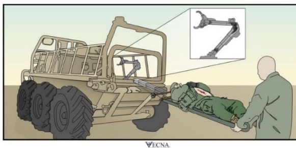
Figur 4.6: RE2 Robotics och Vecna Technologies utvecklar robotarm som ska göra det möjligt för en ensam sjukvårdare att lyfta ombord en skadad på bår på en UGV (illustration: US Army, public domain 53 ).
