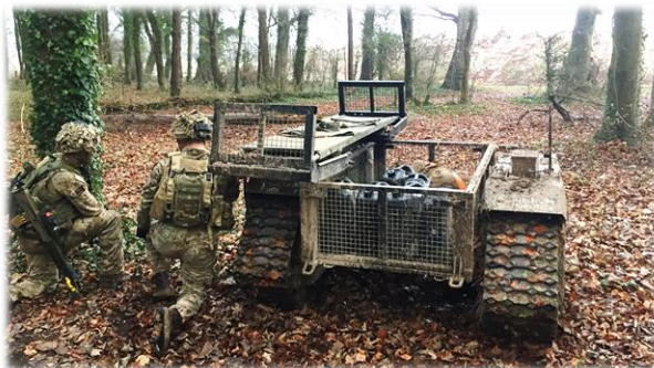
Figur 4.5: MILREM TheMIS utrustad med bärkorg och en enkel bår som användes vid den brittiska övningen AWE18 (foto: FOI).
