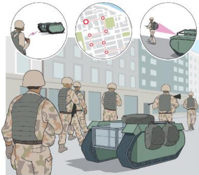
Figur 4.2: Exempel på olika tekniker för att styra en UGV: fjärrstyrning på nära håll med enkel handkontroll, brytpunktsnavigering med möjlighet att upptäcka och väja för hinder och följ-mig funktion (illustration: Martin Ek).
