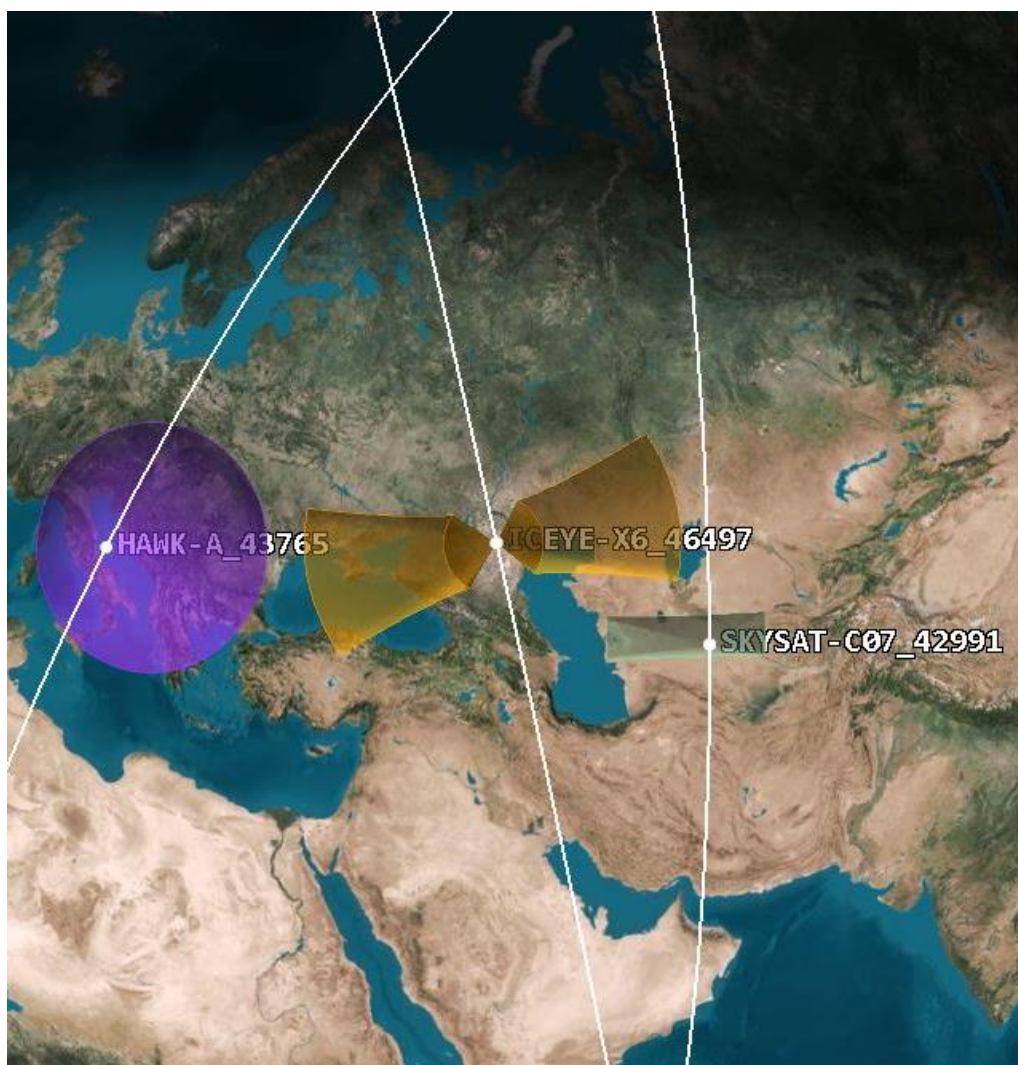
Figur 3 - Alla tre sensortyper och deras respektive formfaktorer. Från vänster: Signalspanning, SAR, Optisk.
