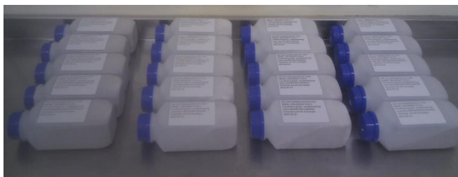
Figur 9. En icke explosiv blandning av 20 % laddning (energetiskt salt + bränsle) och 80 % sand förpackade i plastburkar. (Bild från rapport [4])
