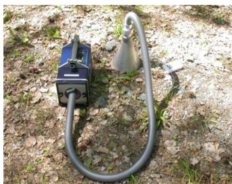
Figur 2. Luftprovtagningspump med tratt innehållande ett C18 filter. (Bild från rapport [2, 19])
