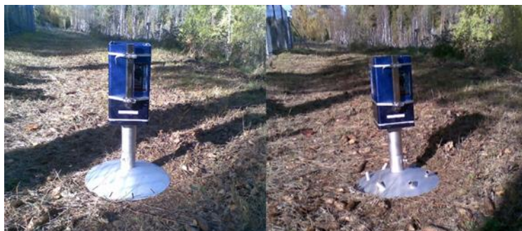
Figur 4. Två olika typer av trattar för luftprovtagning ovan minor. (Bild från rapport [18])
