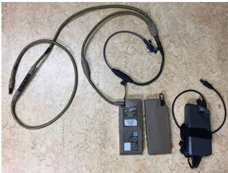
Figur 3. Y-kablage och externt batteri (2 st visas i bild) för laddning under användning. Till höger batteriladdare för externt batteri.
