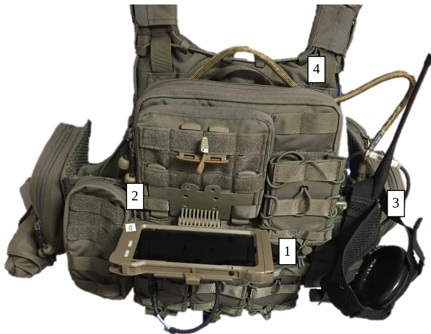
Figur 1. EUD (1) monterad i hållare (2) fäst på stridsväst från FOI, samt Ra1570 (3). Kablaget (4) är här ej trätt genom MOLLE-öglor.
