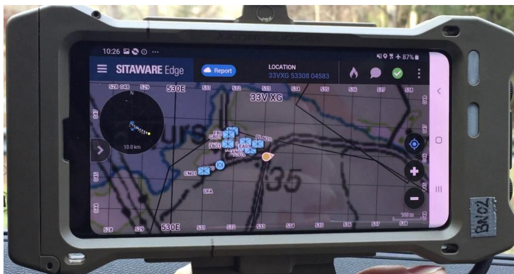
Figur 10. Följning av kompaniövning på buret ledningsstödsystem. Gul egensymbol indikerar att denna EUD inte sänder sin position i nätet.
