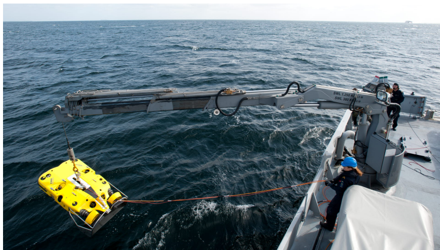
(a) Bilden visar en ROV/AUV som används av Försvarsmakten för minröjning. (Foto: Okänd fotograf, Fjärde sjöstridsflottiljen/Försvarsmakten.)
