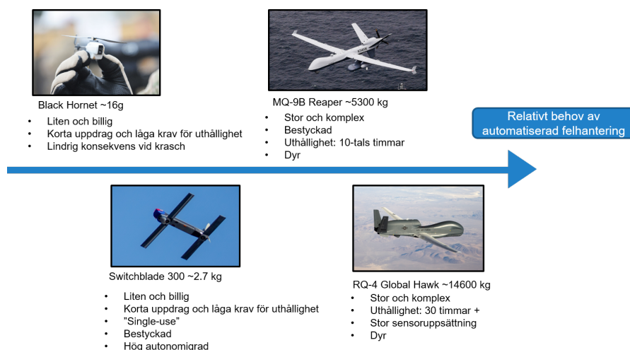
Figur 2.2: Figuren visar luftfarkosters behov av felhantering med några exempelsystem som är i drift idag. Data hämtad från [14]. (Foton: Black Hornet - Richard Watt/MOD, UAV05 - Jesper Sundström/Försvarsmakten, Switchblade 300 - U.S. Marine Corps/Lance Cpl. Tyler Forti, RQ-4 Global Hawk - U.S. Air Force by Bobbi Zapka, MQ-9B Reaper - U.S. Navy by Mass communication specialist Shannon Renfroe)
