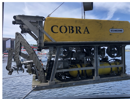
(c) Bilden visar en ROV som har använts för att utföra installationer och underhållsarbeten på ned till 1 000 m djup på de norska oljefälten i Nordsjön. Foto: Karin Kraft
