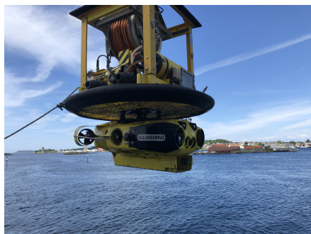
(b) Bilden visar en ROV som har använts för inspektion av installationer på havsbotten vid de norska oljefälten i Nordsjön. Foto: Karin Kraft (FOI)
