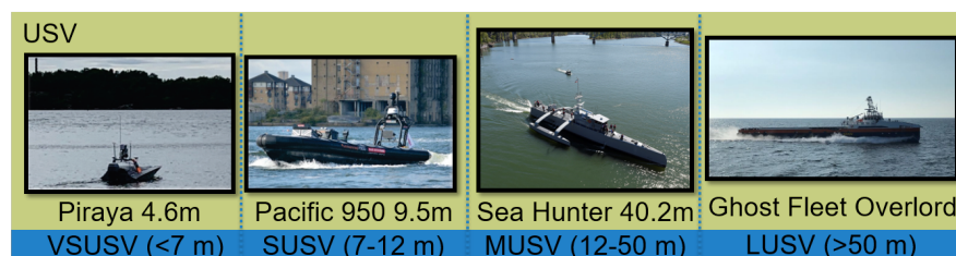
Figur 4.2: Exempel på obemannade ytfarkoster från den minsta klassen till den största. Viktklasser hämtade från [70]. (Foto: Piraya - FOI, Pacific 950 - Alamy Stock Photo, Seahunter , Ghost Fleet Overlord ship - U.S. Navy, U.S. Navy/John F. Williams, Public Domain)
