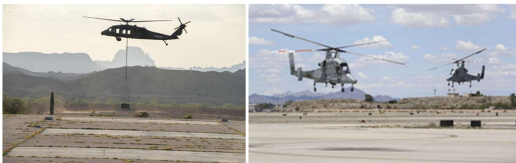
Figur 2.3: Vänster: En obemannad UH-60 Black Hawk utrustad med DARPA ALIAS och Sikorsky MATRIX autonomimjukvara som flög på Yuma Proving Ground (YPG) under US Army Project Convergence Exercise Technology Gateway 2022 (Foto: US Army, Public Domain). 20 Höger: Obemannade K-MAX som har använts av den amerikanska marinkåren för logistikuppdrag i bland annat Afghanistan, YPG 2015 (Foto: USMC, Pfc. George Melendez, Public Domain).
