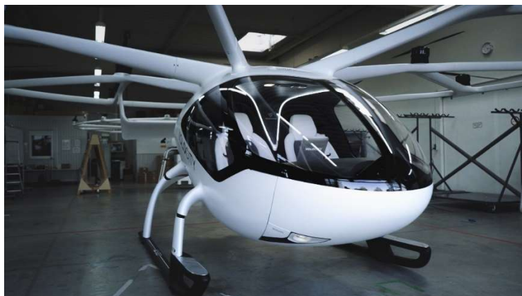
Figure 2.4: VoloCity, en tvåsitsig autonom flygande taxi som utvecklas av det tyska företaget Volocopter (Foto: Raymar Laux, Volocopter GmbH, via wikipedia, CC BY 4.0).
