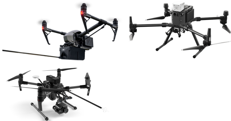
Figur 7. Från vänster till höger: Scentroid Flying lab DR2000 monterad på en DJI Inspire 2, Soarability Sniffer4D monterad på en monterad på en DJI Matrice 300 och FLIR MUVE C360 monterad på en DJI Matrice 210.
