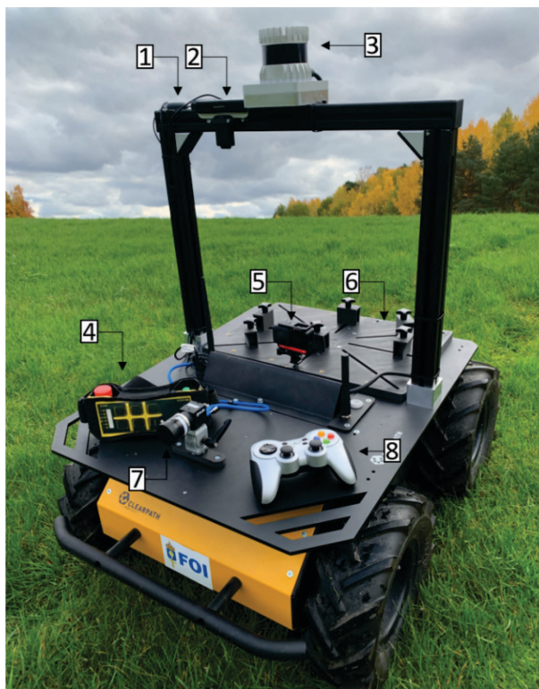
Figur 5.2: Husky UGV med monterade sensorer: (1) GNSS-antenn, (2) stereomikrofon, (3) OS1-32 LiDAR, (4) trådlös nödstoppsknapp, (5) visuell 360°-kamera, (6) fäste för laptop, (7) visuell kamera, (8) joystick för fjärrstyrning (Foto: FOI).
