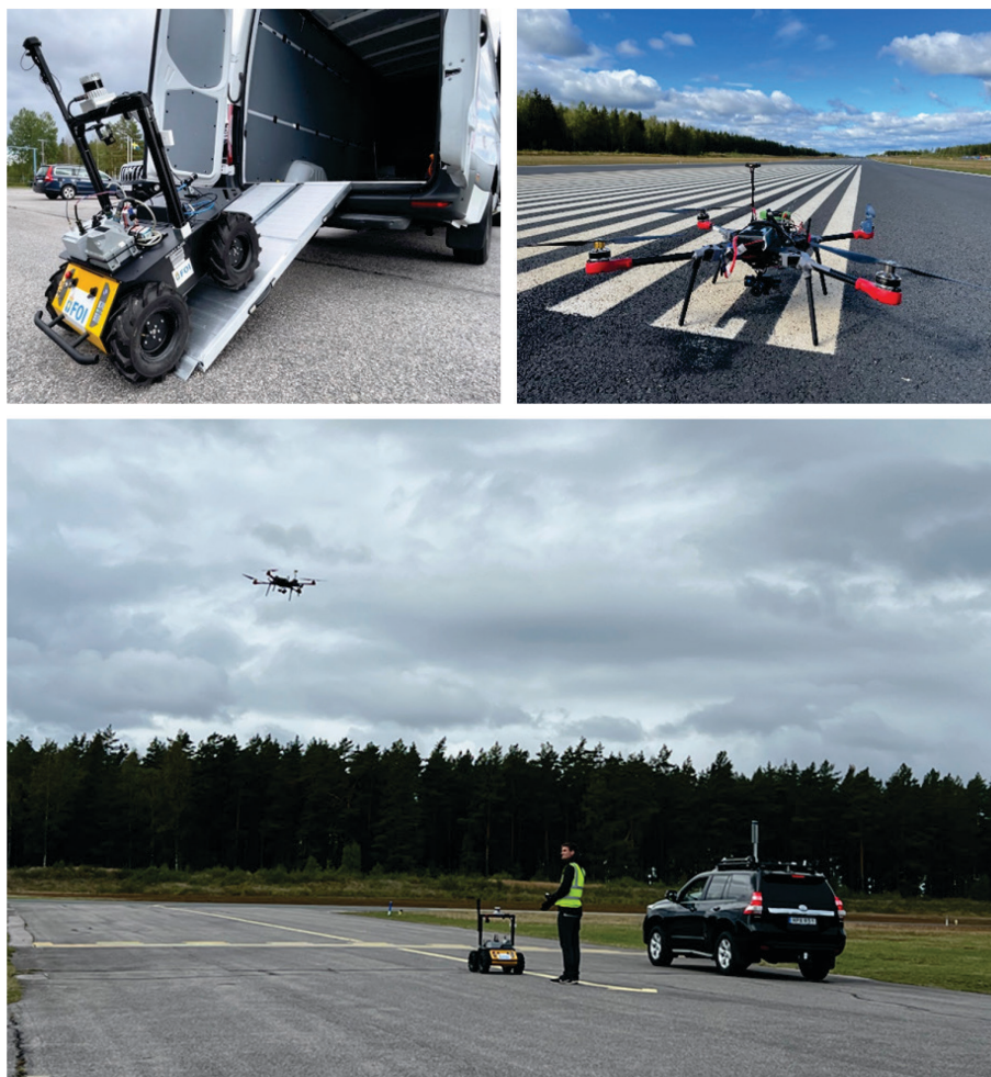
Figur 4.1: Övre/vänster: Husky UGV. Övre/höger: UAV. Nedre: UAV på väg att lyfta för att ta sin position ovanför UGV och Land Cruiser under en mätning. (Fotografier: FOI)
