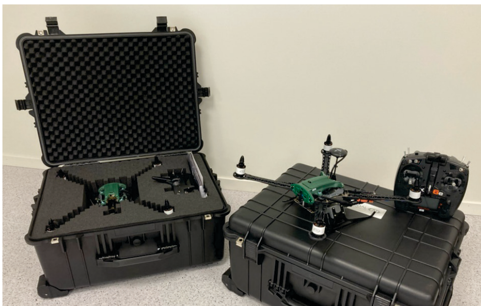
Figur 5.3: Två Sentinel UAV som är baserade på ModalAI VOXL2 (Foto: FOI).
