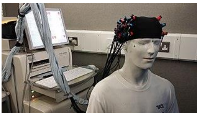
Figur 6. Hitachi ETG4000, headset med optoder för mätning med fNIRS (bild från Wikimedia 14 )
