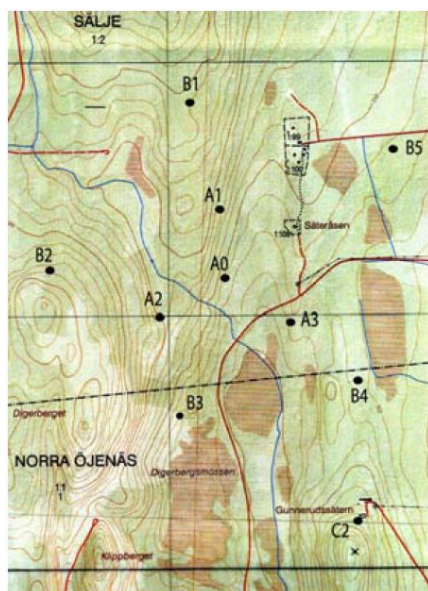
Figur 26: Hagforsstationen är en seismisk arraystation med tio mätpunkter. Diametern för den yttre ringen är 1,4 km. Alla punkter är försedda med bredbandiga trekomponentsinstrument.
