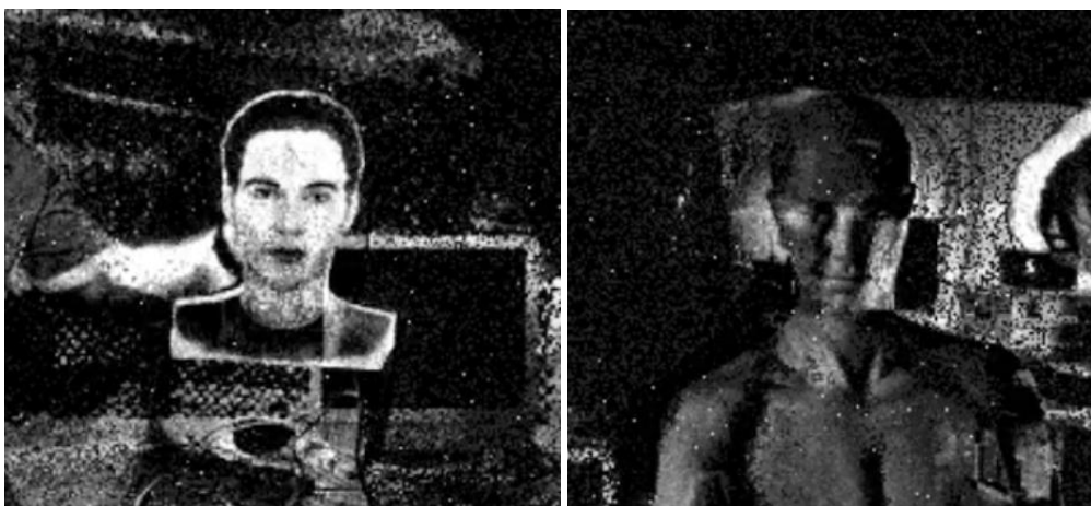
Figur 16: Detaljer av bilder från det inbyggda Accumulator-läget från Dynamic Vision Viewer [12], dvs programvaran till Inivations eventkameror. Gråskalebilder skapas utgående från inkommande events. Observera att rörliga objekt synes vara delvis genomskinliga då även events från bakgrunden kan ha påverkat pixelvärdet innan objektet kom till den positionen. Till vänster ett platt utskrivet ansikte som rörts mestadels upp och ner i bilden. Till höger en tredimensionell skyldocka som har vridits fram och tillbaka några gånger i bilden.
