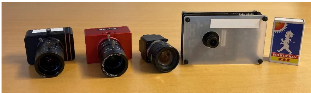
Figur 6 Fyra eventkameror och en storleksreferens. Till vänster DVXplorer och DAVIS346 (som både samlar in events och vanlig bild på samma gång) från Inivation. I mitten SilkyEvCam från Prophesee. Slutligen ett Speck utvecklingskit från Synsense.
