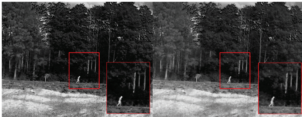
Figur 8. Jämförelse mellan bilder fusionerade med U2Fusion (vänster) respektive med konventionell medelvärdesbildning (höger). Bilder fusionerade med U2Fusion får något skarpare kanter än motsvarande bilder som är medelvärdesbildade från båda banden [11].
