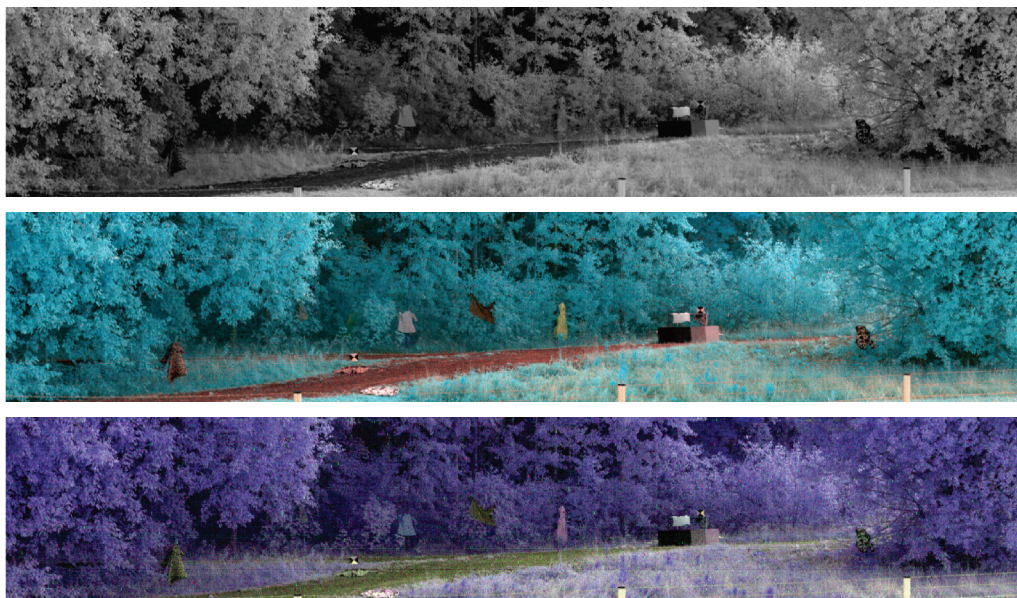
Figur 20. Visualisering av hyperspektrala data. Ett exempel från hyperspektral SWIR-kamera. Överst ett exempel där alla band summerats, som motsvarar hur en bredbandig kamera skulle avbilda scenen. Mitten och nederst visas två olika exempel där tre band plockats ut och visas som en färgbild.
