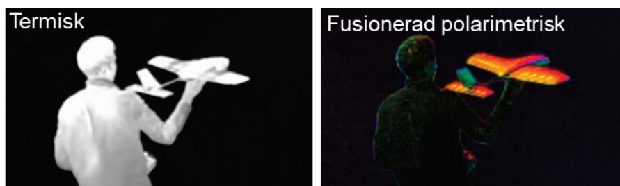
Figur 30. Exempel på data från den nya polarimetriska QWIP-kameran med känslighet i termiska LWIR-bandet. Till vänster: Konventionell termisk, till höger: fusionerad polarimetrisk där slätare ytor framträder.
