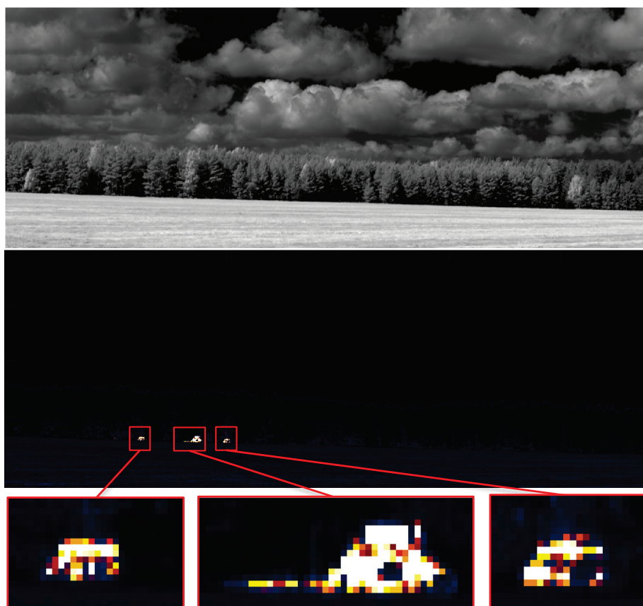
Figur 19. Anomalidetektion i SWIR baserat på en bakgrundsmodell. Detektionen görs med spektral matchning med en modell av en skogsbakgrund. Översta panelen visar en pankromatisk SWIR-bild av scenen.
