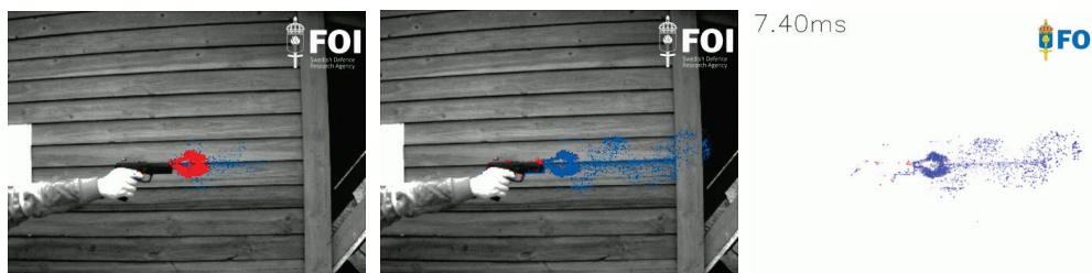
Figur 41. Skjutning med pistol på kort avstånd. Eventdata överlagrad i motsvarande visuell bild till vänster och i mitten. Mynningsflamman och dess dynamiska förlopp framträder tydligt. I bilden i mitten framträder även event från brytningsförändringar orsakade av mynningsflamman och kulans rörelse. I bilden till höger visas endast eventdata.
