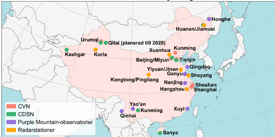
Figur 24. De olika typerna av markstationer som man tror kan bidra till Kinas och PLA:s rymdlägesbild. De röda markeringarna är stationer i China VLBI Network (CVN), de gröna tillhör China Deep Space Network (CDSN), de lila är Purple Mountain-observatorier och de orangea är radarstationer. Data sammanställd från [395] [396] [397] [398] [399] [400].
