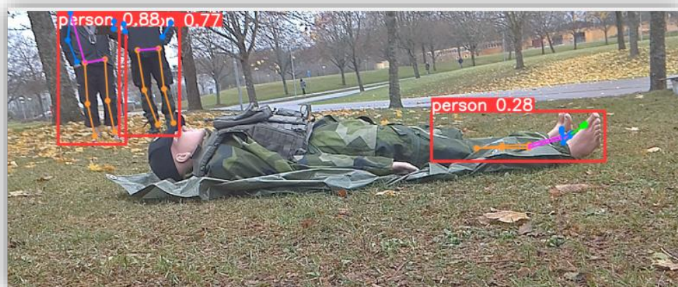
Figur 7. Inledande försök med kroppsställningsdetektion i utomhusmiljö. Algoritmen klarar att detektera och analysera de stående personerna i bakkant av bilden trots att endast delar av dem syns. Resultatet för den liggande personen (dockan) är dock som synes helt felaktigt.
