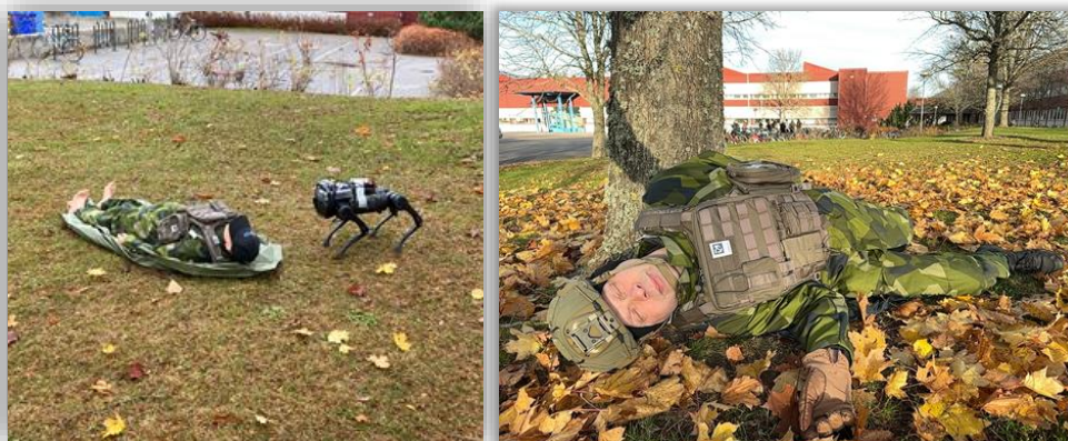
Figur 3. Bilder från försök i projektet syftandes till att studera prestanda för ett antal existerande algoritmer och dra slutsatser om hur de bör anpassas för att prestera väl i projektets scenario. Till vänster ett med försöksdocka, och till höger ett med en verklig person för att få termisk signatur.
