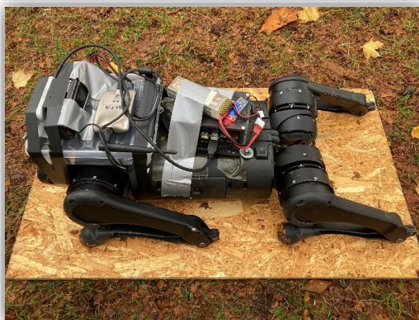
Figur 4. Kerasystem plus batteri provisoriskt fastsatt på en robothund av modell Unitree A1.
