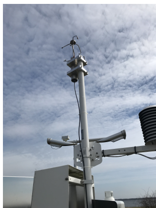
Figur 3.2: Bild på mätinstrument för registrering av optisk turbulens som installerades i Karlskrona tillsammans med FM/METOCC.
