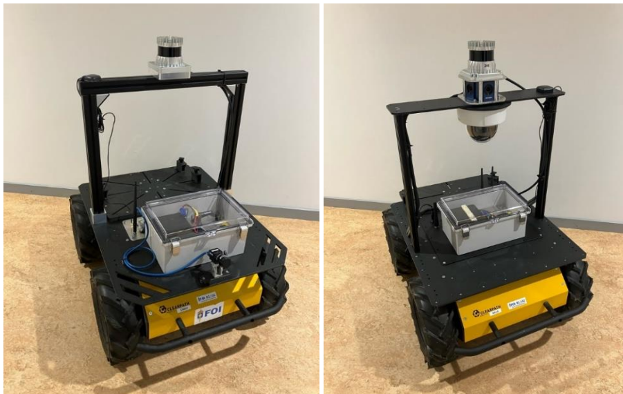
Figur 3.2: De två UGV:erna, av typen Husky A200, med olika sensorkonfigurationer. Vänster: LiDAR och kamera. Höger: LiDAR, 360-kamera och Pan-Tilt-Zoom – PTZ – kamera (foto: FOI).
