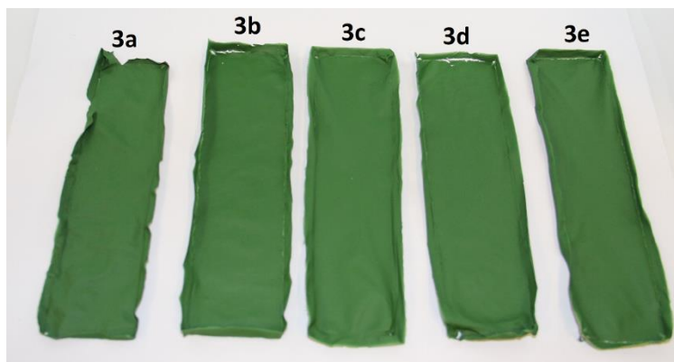
Figur 2: Färgade nanocellulosaprover som användes för hållfasthetstester.
