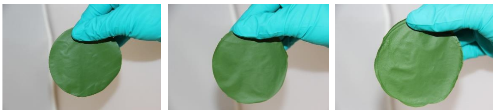
Figur 1: Färgade nanocellulosaprover för optiska mätningar.
