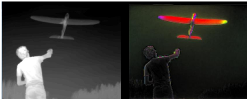
Figur 2. Till vänster visas en termisk bild (Long Wave Infrared) tagen med en Phoenix 5.0 MP Polarization Model. Till höger visas polarimetrisk bild tagen med samma kamera. Bild från FOI-R--5553—SE.
