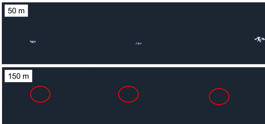
Figur 3: Detektion och följning av drönare med Prophesee EVK4, från FOI-R--5543--SE 9 .
