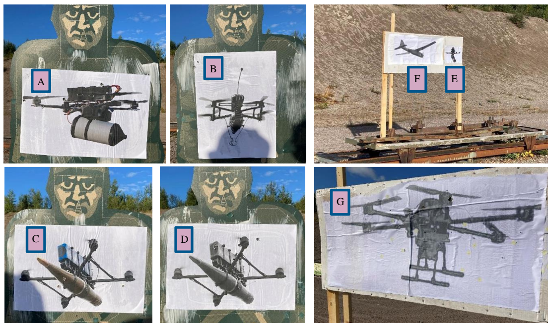
Figur 5. Målfigurer monterade på pappfigur för skjutning. Till vänster mål A-D med FPV-drönare, till höger ovan Orlan 10-drönare mål F, FPV-drönare mål E, samt nedan multikopter-drönare mål G.
