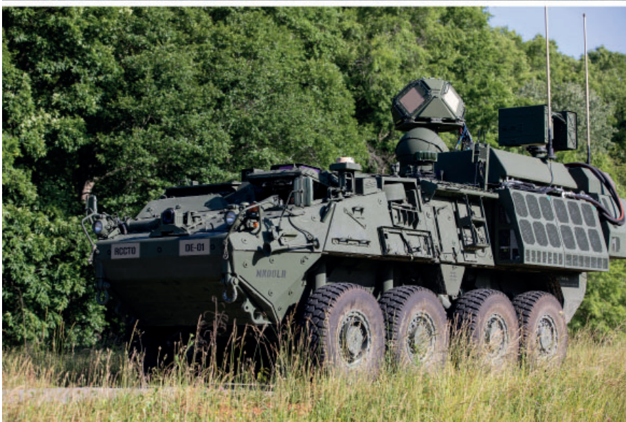
Figur 9 Överst, Boeings system CLWS (5 kW) monterat på en Polaris jeep (foto: FOI). Nederst, US Army 50 kW prototyp integrerat på ett Stryker fordon (Källa: US Army Jim Kendall).
