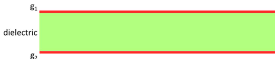
Figur 9: En sidovy av enhetscellen som designas i [32]. Två membran ( g_1, g_2 ), med ett mellanliggande dielektriskt material.
