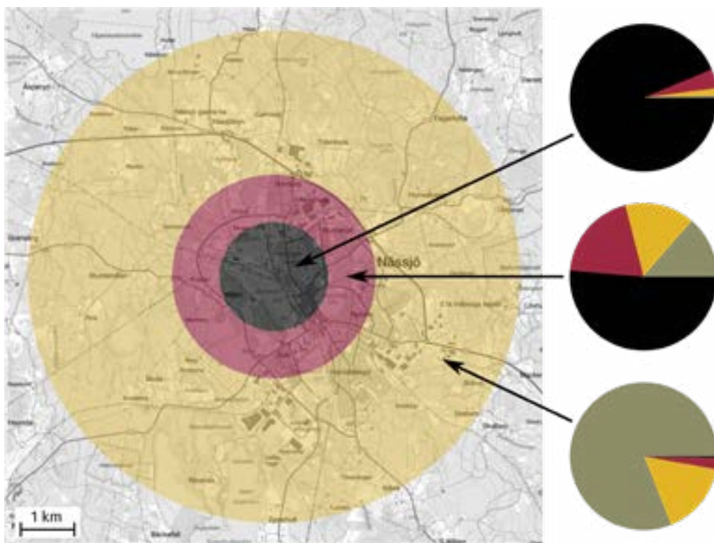
Zonindelning baserat på byggnadsskador (svåra, måttliga, lindriga) efter en tio kilotons luftexplosion. Cirkeldiagrammen visar andelen döda (svart), svårt skadade (rött), måttligt skadade (gult), samt lindrigt skadade och oskadade (grönt). Kartunderlag: Lantmäteriet.
