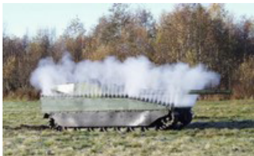
Figur 69. Vattendimma applicerat på ett stridsfordon. Här avskärmas vagnen från hot uppifrån, till exempel slutfasstyrda granater. Det tar cirka tre sekunder innan vagnen är helt täckt av vattendimman (bilden till höger).
