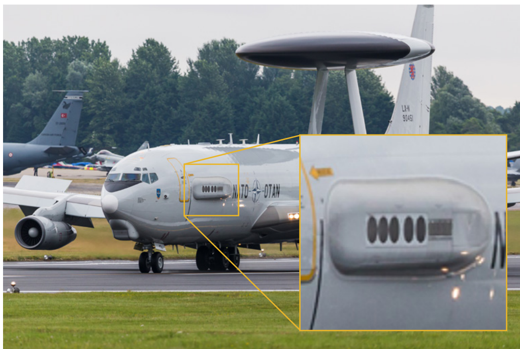
Figur 38. För rikttningsbestämning med interferometri används ofta antenner med 3–5 antennelement som pekar i samma riktning och sitter på rad, se den högra delfiguren. Typiskt för så kallade linjära interferometerarrayer är att avståndet mellan antennelementen inte är identiskt. Den användbara sektorn är ca \pm 60^\circ relativt riktningen tvärs flygplanskroppen. Bilden visar en installation på ett AWACS-flygplan. (Foto: Jason Wells/Shutterstock.)
