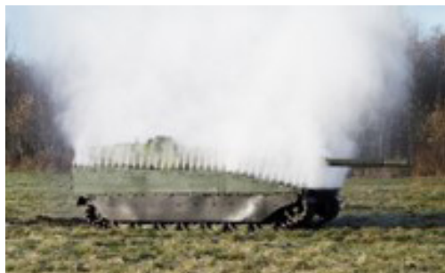
Figur 69. Vattendimma applicerat på ett stridsfordon. Här avskärmas vagnen från hot uppifrån, till exempel slutfasstyrda granater. Det tar cirka tre sekunder innan vagnen är helt täckt av vattendimman (bilden till höger).
