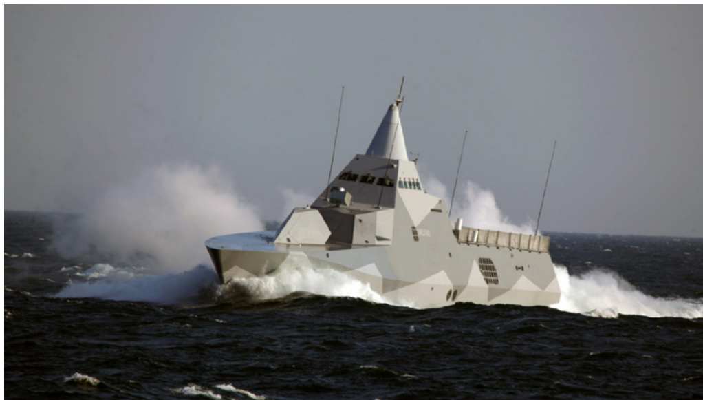
Figur 36. Korvett HMS Karlstad. Högst upp på fartyget sitter antennen för signalspaning innanför en konisk radom. Systemet kan varna för radarbaserade hot och skapa en lägesbild genom att upptäcka, mäta in och identifiera radarsignaler samt de sändande radarsystemen och plattformarna. Foto: Jimmie Adamsson/Försvarsmakten.
