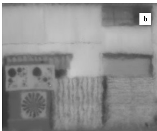
Figur 12. Bilder av upplösningstavlor vid låg (a) respektive hög turbulens (b).
