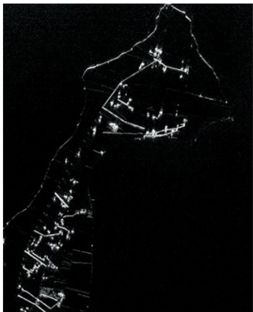
Figur 51. Till vänster visas en SAR-bild (ostörd) från ett fältförsök över norra Visingsö. Till höger motsvarande bild, där SAR-radarn har blivit utsatt för störsändning. Den utsända störeffekten är cirka 10 W.
