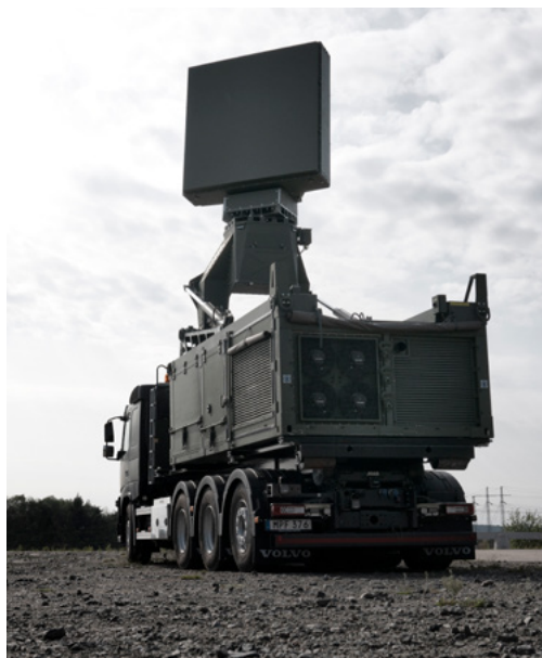
Figur 34. Svensk luftspaningsradar Giraffe 4A. Systemet är en pulsad radar på 3 GHz som har en räckvidd på flera hundra kilometer. Pulsrepetitionsfrekvens och pulslängd är varierbara. Copyright Saab AB. Foto Stefan Kalm.
